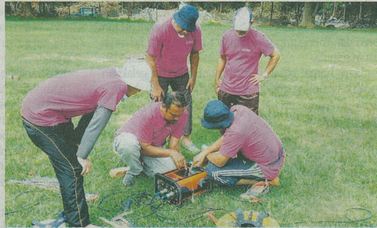
Kumpulan pakar dari FKAAS menggunakan alat khas untuk mengesan struktur tanah bagi membina telaga tiub.
